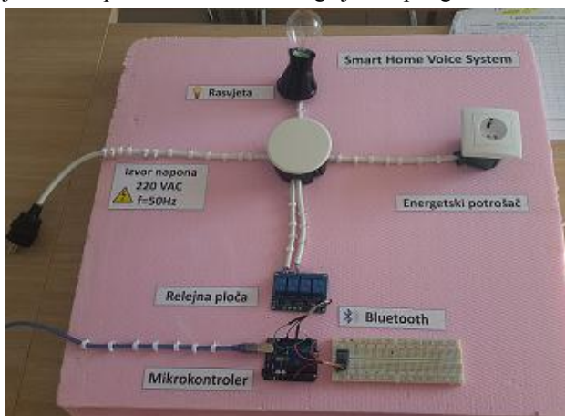
Sl. 8. Maketa praktično realizovanog sistema
